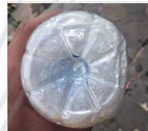
Gambar 1. Ecobrick tanpa Serbuk Kayu Mengalami Deformasi
